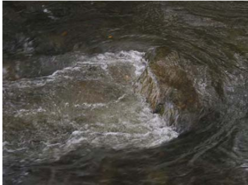
Abb. 5: Ausbildung einer Rückströmung an einem pyramidenförmigen Block
