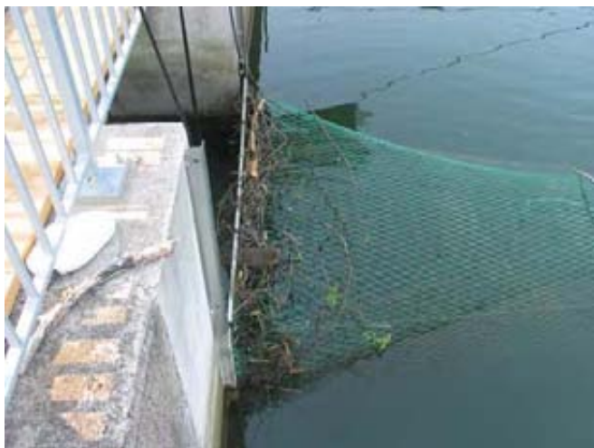
Abb. 34: Effizienzkontrolle am Ausstieg der Fischwanderhilfe mittels Reusenfang
